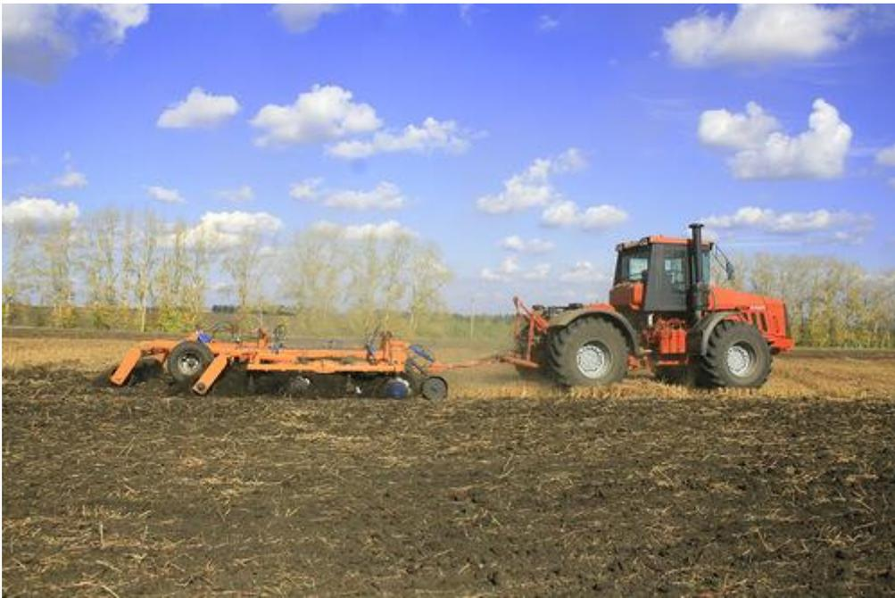
Трактор "Кировец" К-744Р3 "Премиум" (двигатель Mercedes, 401 л.с.) работает с 6-метровой 4-рядной дисковой бороной. Борона дисковая прицепная БДМ 6х4ПМ предназначена для рыхления и подготовки почвы под посев; уничтожения сорняков и измельчения пожнивных остатков; для предпосевной подготовки почвы без предварительной вспашки и обработки почвы после уборки толстостебельных пропашных культур.
